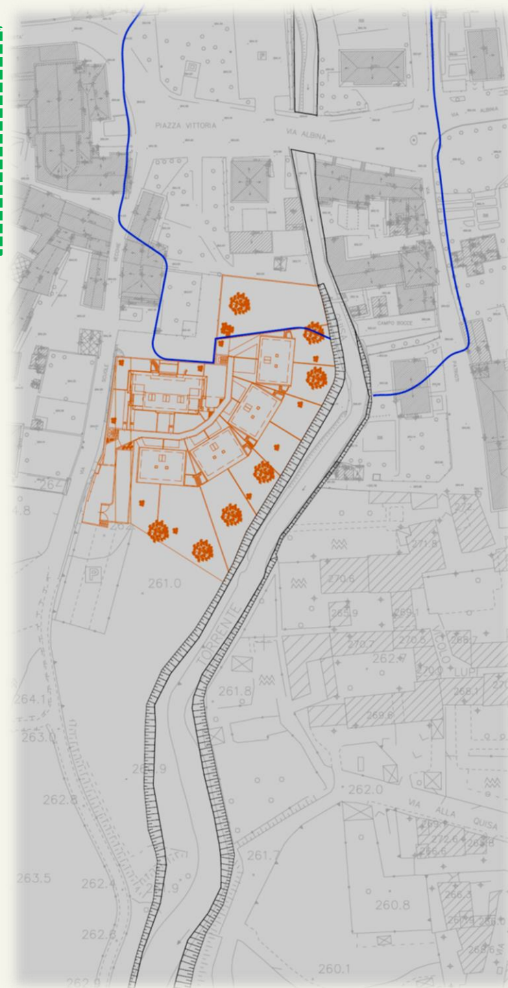
Allagamenti TR 100 anni
