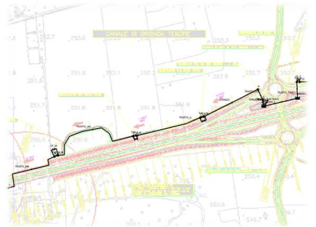
Modello SWMM: schematizzazione rete di drenaggio lungo canale di gronda.
