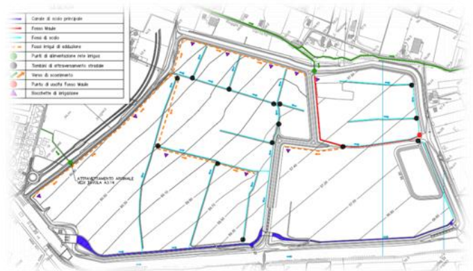
Riconfigurazione del reticolo irriguo e di colo interno alla cassa
