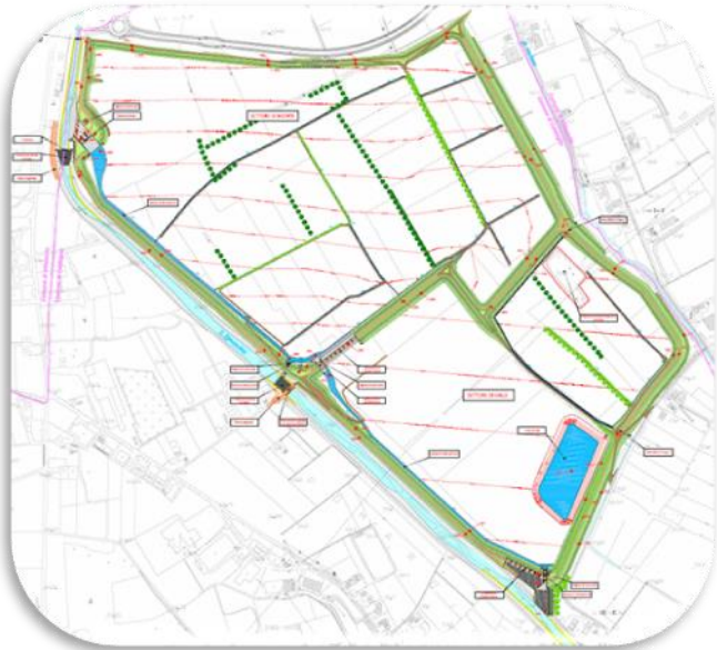
Planimetria di progetto dell'area di laminazione
